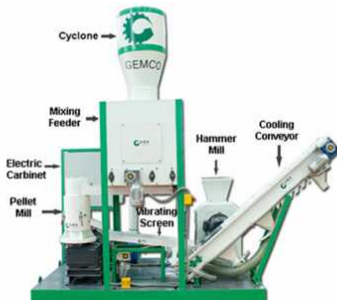
Figura 79 Planta de producción de pellet móvil (GEMCO ENERGY, 2017)
